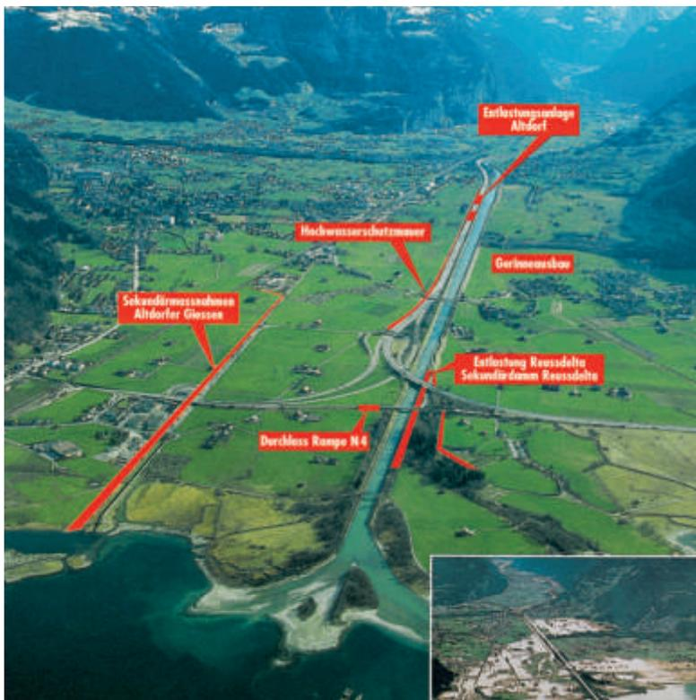
Das Hochwasser von 1987 führte im Urner Reusstal zu drei Dammbrüchen und grossen Überschwemmungen (kleines Bild). Die ausgeführten Hochwasserschutzmassnahmen umfassen neben dem Gerinneausbau auch Massnahmen zur Beherrschung des Überlastfalls. Wird die Ausbauwassermenge überschritten, so fliesst Wasser auf die Autobahn. Eine Hochwasserschutzmauer und Sekundärmassnahmen beim Altdorfer Giessen verhindern, dass Siedlungsgebiete mit hohem Schadenpotenzial überflutet werden.
