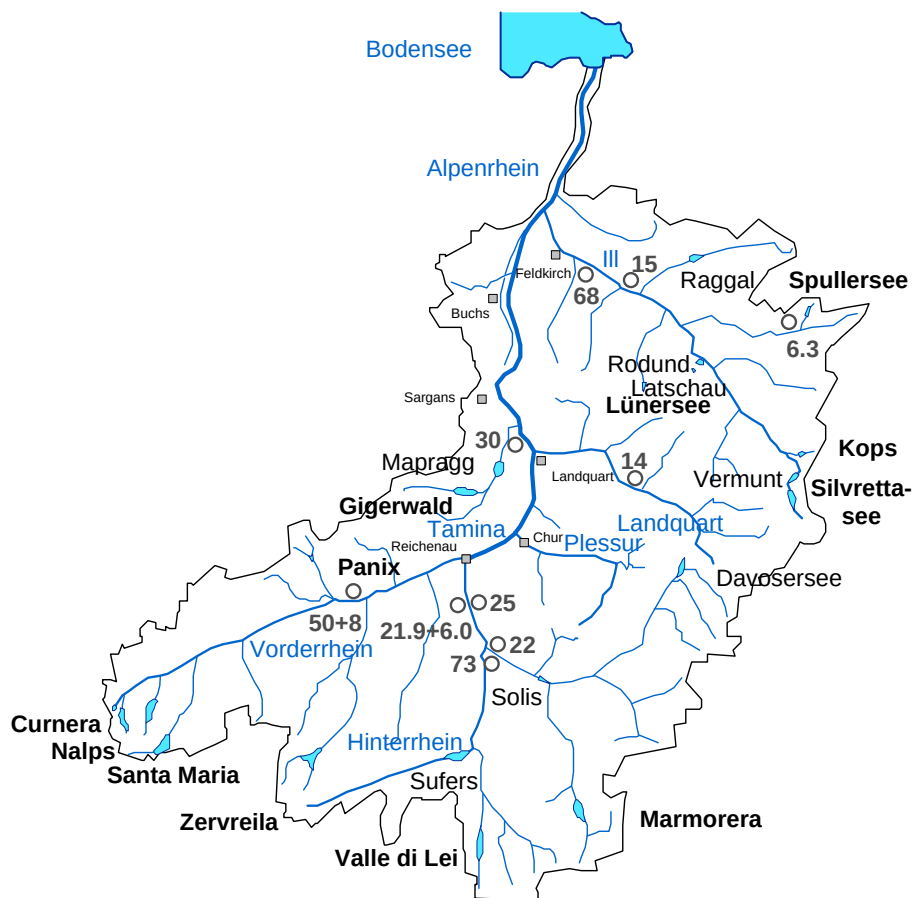
Bild 9: Einzugsgebiet des Alpenrheins mit den Standorten der grossen Speicherseen (fett) sowie den Zentralen mit den installierten Turbinenleistungen in m 3 /s.
