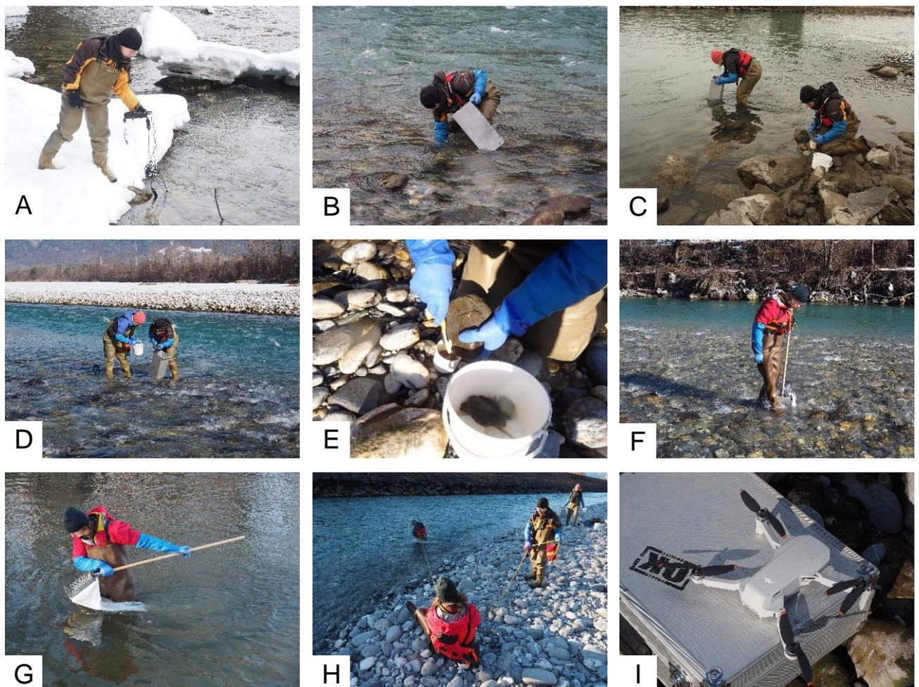
Abbildung 3. Probenahme an den Untersuchungsstellen. A...*in situ* Messung chemisch-physikalischer Parameter. B bis E...Phytobenthosaufnahme, Begehung mit dem Sichtkasten, Abschaben der Kieselalgenbeläge. F bis H...Probenahme des Makrozoobenthos (MHS-Methode), in starker Strömung auch vom Ufer aus gesichert. I...Drohne für Überblicksaufnahmen.
