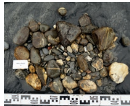
Abb. 104: Mittels UW-Sampler beprobte Teilflächen (Teilproben 1-3). TP1-3 = Teilproben; WT = Wassertiefe. Kolmationskategorien: Stufe 1 = ● keine Kolmation; Stufe 2 = ● geringe Kolmation; Stufe 3 = ● mittlere/mäßige Kolmation; Stufe 4 und 5 = ● starke und/oder äußere Kolmation. Fotos: HYDRA 2015 ©.
