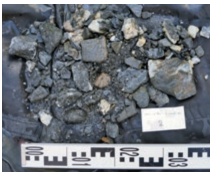
Abb. 81: Nur die Teilprobe 2 enthielt ausreichend grobes Sohlenmaterial, um die Korngrößenzusammensetzung zu charakterisieren. Das Substrat mit kantigen Kies- und Steinfractionen deutet auf seine Herkunft aus der Uferschüttung rechts (siehe Abb. ##). Die anderen Teilproben waren schlammig-sandig. Mit dem Sampler wurde die eigentliche Flusssohle also nicht erreicht. Foto: HYDRA 2015 ©.
