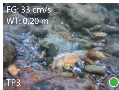
Abb. 68: Mittels UW-Sampler beprobte Teilflächen (Teilproben 1-3). TP1-3 = Teilproben; WT = Wassertiefe. Kolmationskategorien: Stufe 1 = ● keine Kolmation; Stufe 2 = ● geringe Kolmation; Stufe 3 = ● mittlere/mäßige Kolmation; Stufe 4 und 5 = ● starke und/oder äußere Kolmation. Fotos: HYDRA 2015 ©.
