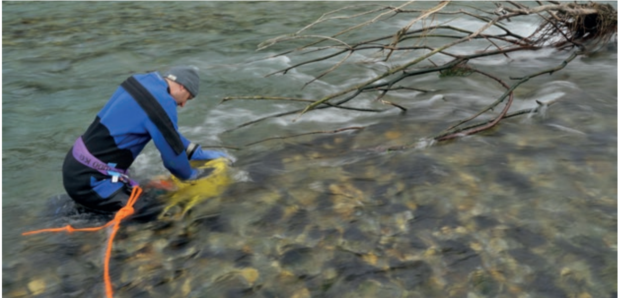
Abb. 75: Probenahme in der Hauptrinne sind nur bei Sunk möglich. Selbst in weniger als 40 cm Wassertiefe herrschen z.B. an der Stelle der Teilprobe 2 noch Fließgeschwindigkeiten von über 1 m/s. Gut besiedelte Flächen erkennt man am Schlauchalgenaufwuchs. Das entsprechende Substrat bleibt auch bei Schwall weitgehend stabil. Foto: HYDRA 2015 ©.
