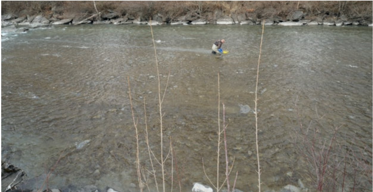
Abb. 91: Um an der Stelle LAQ-Landquart Benthosproben zu sammeln, müssen Sunkverhältnisse abgewartet werden. Bei Schwall lässt sich der Bereich der Teilproben wegen zu starker Strömung nicht erreichen. Foto: HYDRA 2015 ©.
