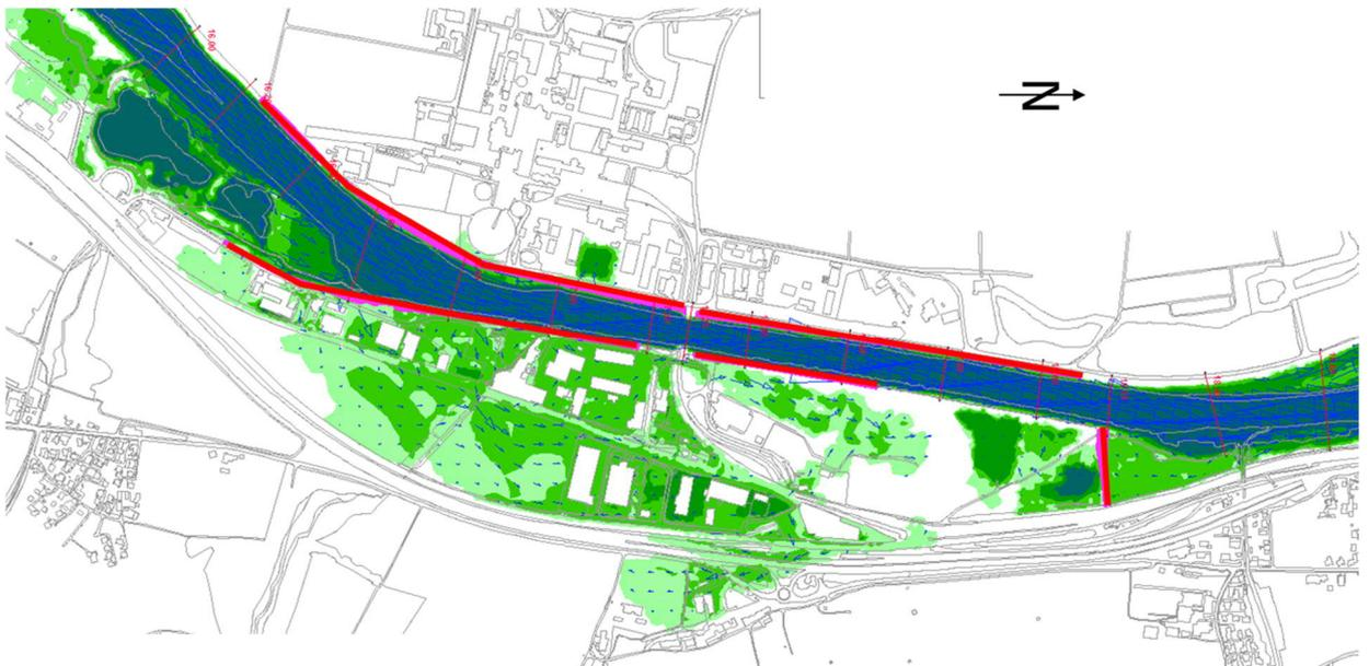
Abbildung 6: Beidseitige Dammsanierungen im Abschnitt Untervaz/Trimmis (rot). Grüne Überflutungsflächen:  $EHQ_A$  im Istzustand (erste provisorische Rechnung, nur indikativ)
