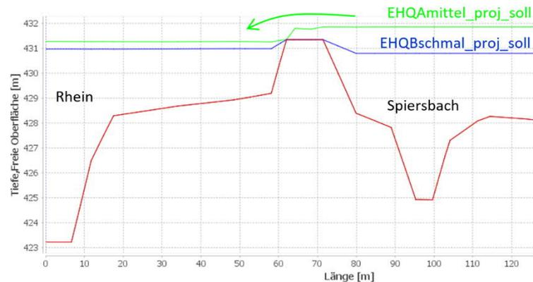
Dammüberströmung: gemäss Längenprofil Abbildung 37 kann die Überströmstrecke in vier Abschnitte unterteilt werden, welche je ein unterschiedliches Verhalten aufweisen:
