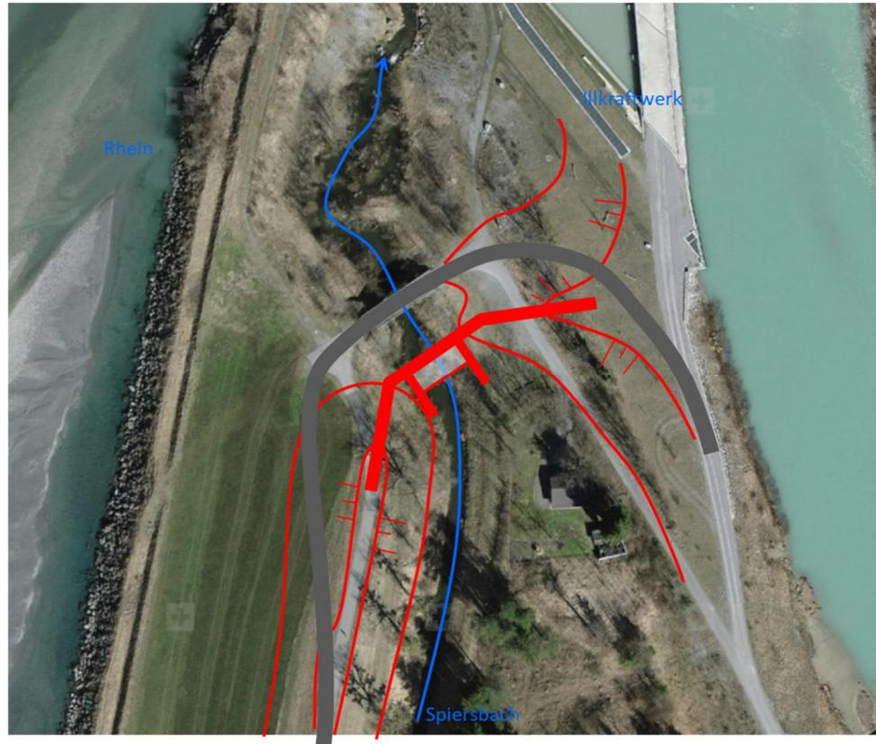
Abbildung 34: Situationsskizze mit einer möglichen Implementierung des Absperrorgans bei der Spiersbachmündung und seiner seitlichen Einbindung in die Rhein-Überströmstrecke sowie in den Illdamm beim Kraftwerk Illspitz.
