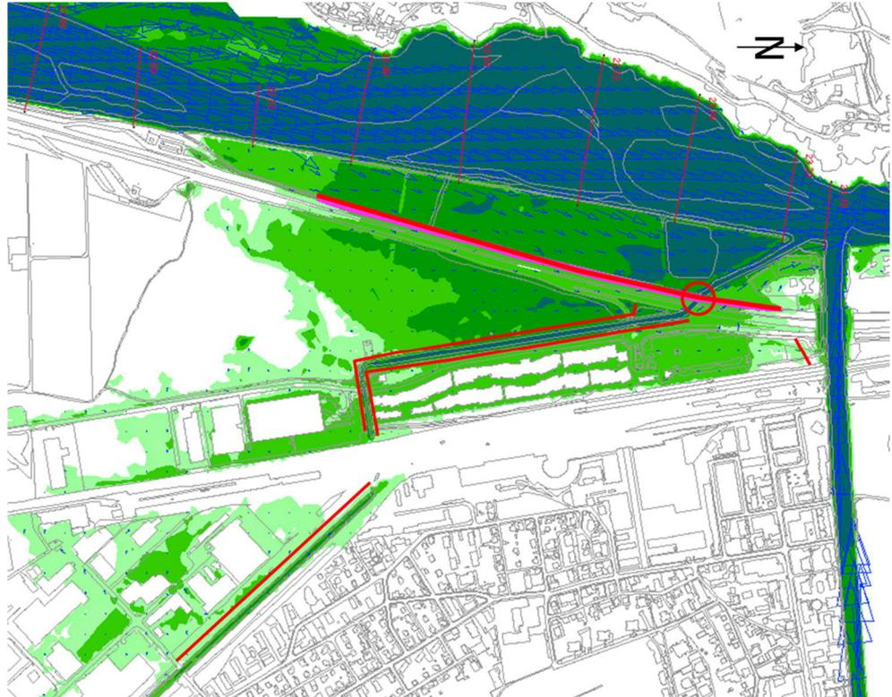
Abbildung 11: Massnahmen bei Landquart: westseitige Anschüttung an den Autobahndamm Rot, kräftig) sowie Rückflussverhinderung Igiser Mühlbach, entweder durch Wehrverschluss (roter Kreis) oder durch Ufererhöhungen bachaufwärts bis zur Sägenstrasse (rot, dünn). Grüne Überflutungsflächen:  $EHQ_A$  im Istzustand (erste provisorische Rechnung, nur indikativ)
