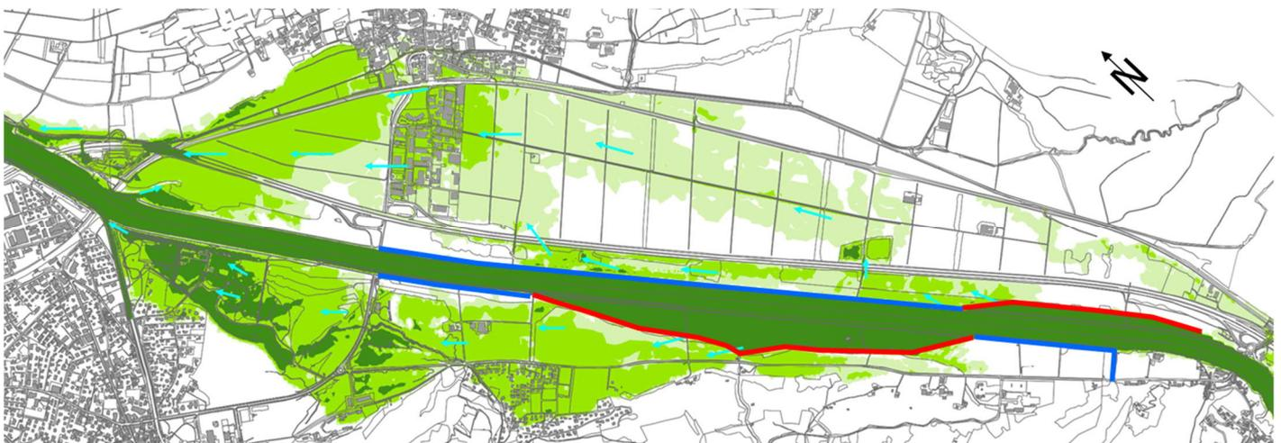
Abbildung 14: Abschnitt Maienfeld – Bad Ragaz mit den nach dem Bau der Rheinaufweitung bei einem EHQ<sub>B</sub> verbleibenden Überflutungsflächen. Rot: Dammsbrückungen mit ausgeflachten überströmbareren Dämmen. Blau: bestehenbleibende Dammelinien mit optionaler Ausflachung. Grüne Überflutungsflächen: EHQ<sub>B</sub> im Projektzustand
