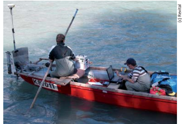
Abb. 8: Echolotvermessung der Flusssohle mit GPS-basierter Echtzeitortung
