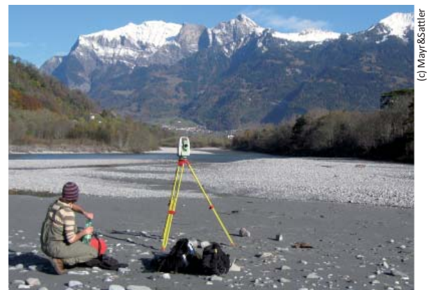
Abb. 9: Strukturen im Abflussraum, Wasserspiegellängen und die Wassertiefen in watbaren Flussabschnitten werden terrestrisch vermessen.
