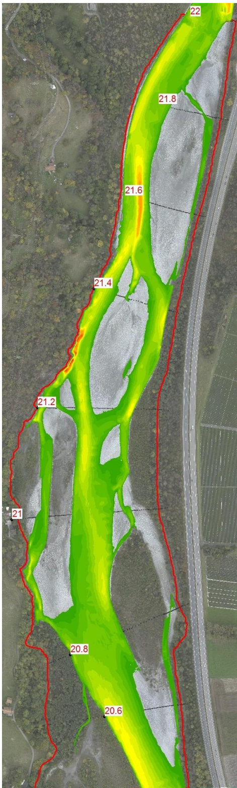
Abb. 15: Fliesstiefen Anforderungsprofil 4 mit konstantem Abfluss von 95 m³/s; Farbabstufung in 0.2 m-Schritten von 0.2 m (dunkelgrün) bis 3.6 m (rot)).
