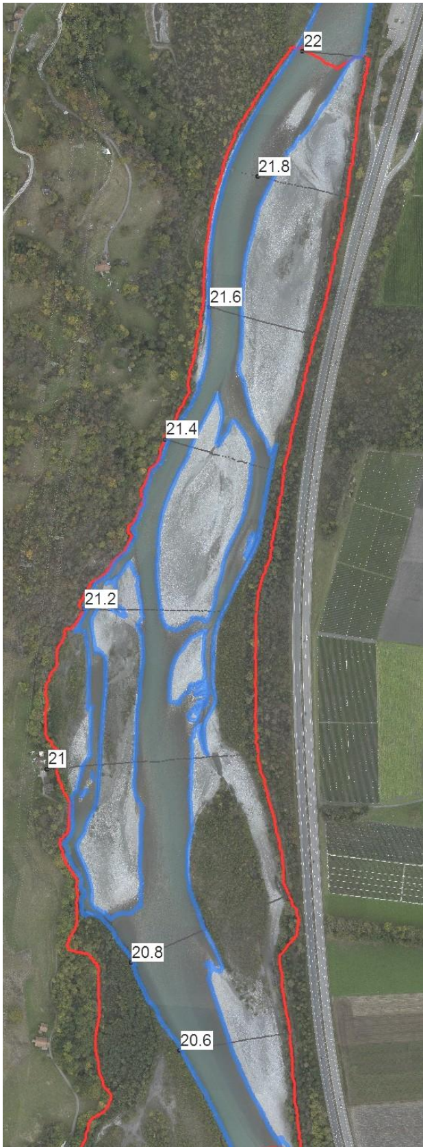
Abb. 10: Vergleich der benetzten Fläche im Orthofoto vom 25. Okt. 2009 und mit benetzter Fläche aus dem numerischen Modell für einen Abfluß von 45 m 3 /s (blau). Der Untersuchungsperimeter ist rot umrandet.
