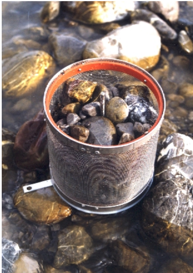
Abb. 5.1: Die modifizierten Vibert-Kästen werden mit an der Probestellen vorgefundenem Substrat befüllt.
