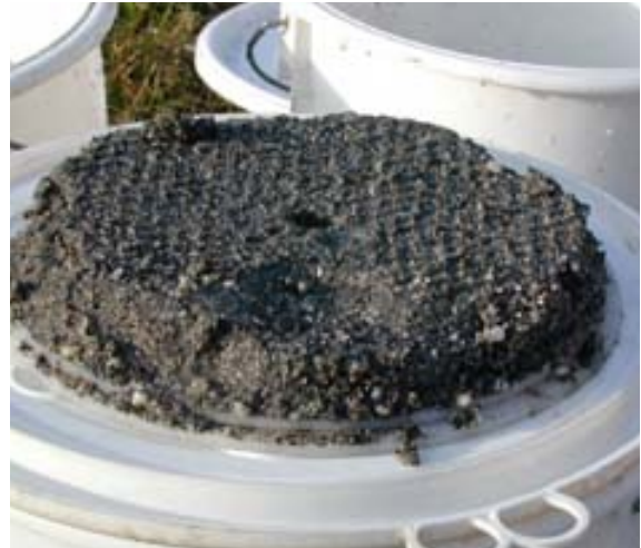
Abb. 39 Am Alpenrhein war der "Klarwasserraum" an der Sohle der modifizierten Vibertkästen vielfach durch eingeschwemmtes Sediment vollständig verlegt.
