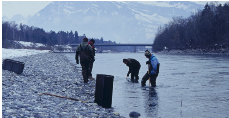
Abb. 35 Die 100 modifizierten Vibert-Kästen werden an jeder Beprobungsstelle in 3 charakteristische Flussbettbereiche "oberhalb Riffel", "unterer Teil Riffel", und "entlang Kiesbank" eingebracht. In jeden Kasten werden im Spätherbst 200 Seeforelleneier eingeschwemmt. Die Kästen werden Ende Feb. (Dorfbach) bzw. Mitte März wieder entnommen und die Zahl der Larven, Eier im Augenpunktstadium und sonstiger lebender Eier bestimmt.
