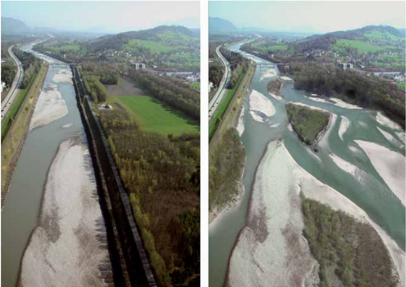
Abb. 4.3: Studie (Visualisierung) der im EKA geplanten Aufweitung des Alpenrheins an der Eschener Au (Liechtenstein). Linkes Bild: heutiger Zustand; rechtes Bild: prospektiver Zustand (Fotomontage: HYDRA 2003). Bei Umsetzung solcher Massnahmen werden zuvor nicht vorhandene Gewässer und wasserabhängige Landflächen in die Untersuchungen eines Umsetzungs-Monitorings mit einbezogen.
