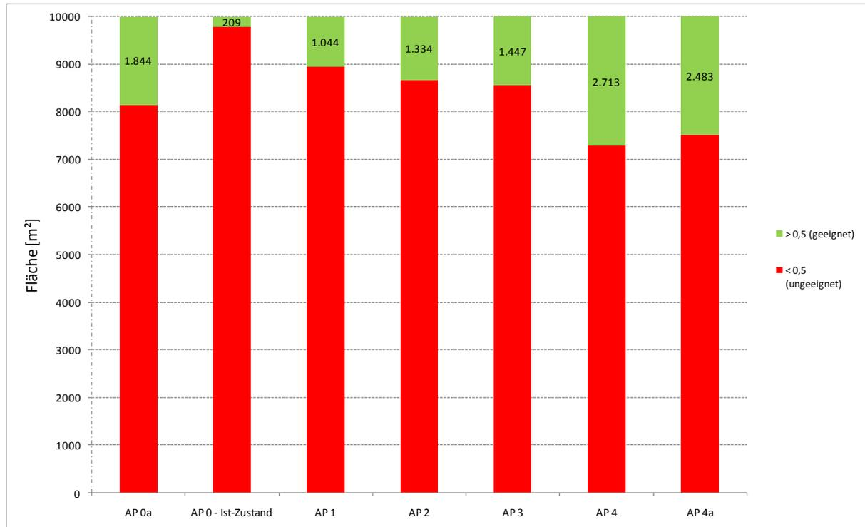
Abb. 72: Jungfische Drift – Darstellung der „Effektiven Lebensraumeignung“ für temporäre Seitenarme pro Hektar je Anforderungsprofil und Referenzabfluss im Abschnitt Mastrils
