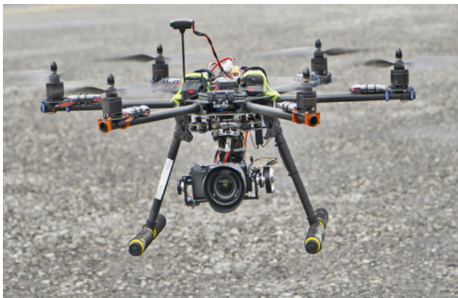
Abb. 5: Multikopter mit Fotoapparat.
