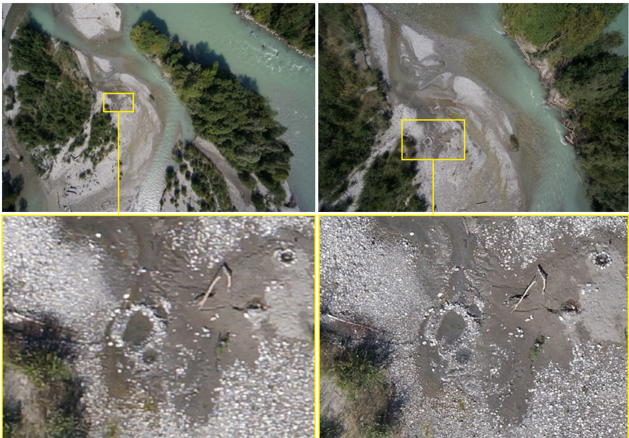
Abb. 6: Drohnenaufnahmen derselben Flussbereiche (Abschnitt Bonaduz) aus 60 m (linkes Bildpaar) und aus 30 m Höhe (rechtes Bildpaar) mit ihren jeweiligen Auflösungsgrenzen
